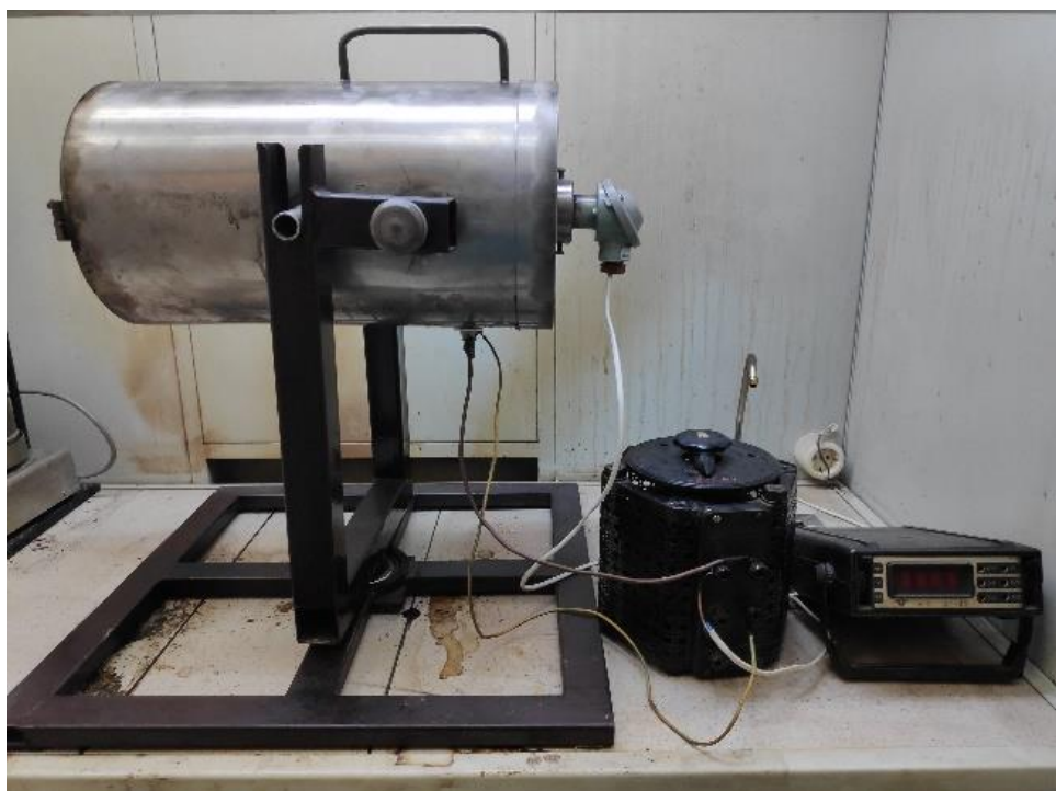
Сурет 1-инертті атмосферада өсімдік шикізатын карбонизациялауға арналған қондырғы
