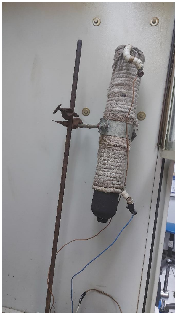
Сурет 2-қызып кеткен су буымен белсендіруге арналған қондырғы
